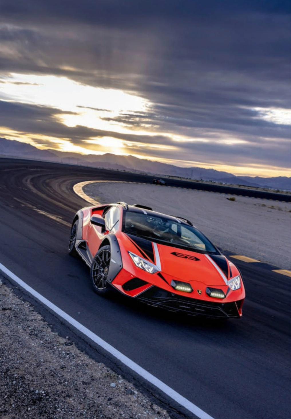
La Sterrato est rehaussée de 44 mm par rapport à l'Huracán Evo. Elle conserve évidemment la transmission aux quatre roues mais se dispense de l'essieu arrière directionnel. Le V10 atmosphérique de 5,2 litres passe de 640 à 610 ch.
