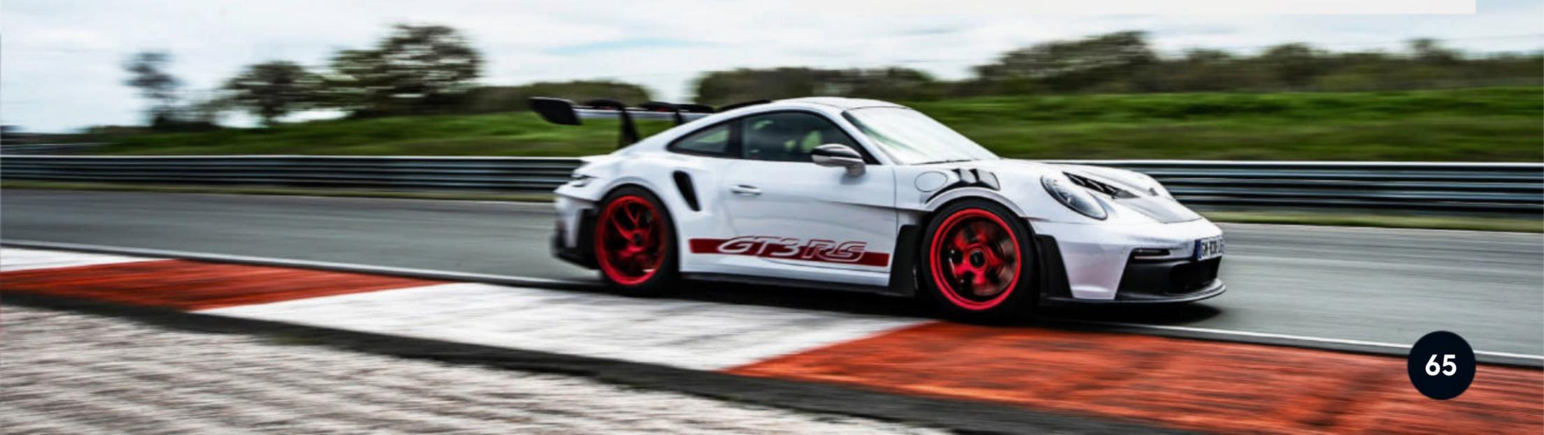
Facturé 36 696 €, le pack Weissach utilise du PRFC avec finition carbone apparente sur l'arceau (- 6 kg), le capot, le toit, la partie mobile de l'aile, les coques de rétroviseurs, les triangles de fenêtres, les barres stabilisatrices ou les plaques de renforts châssis. Le magnésium s'invite sur les jantes allégées (- 8,7 kg pour les 4) ou les palettes de changement de rapport.
