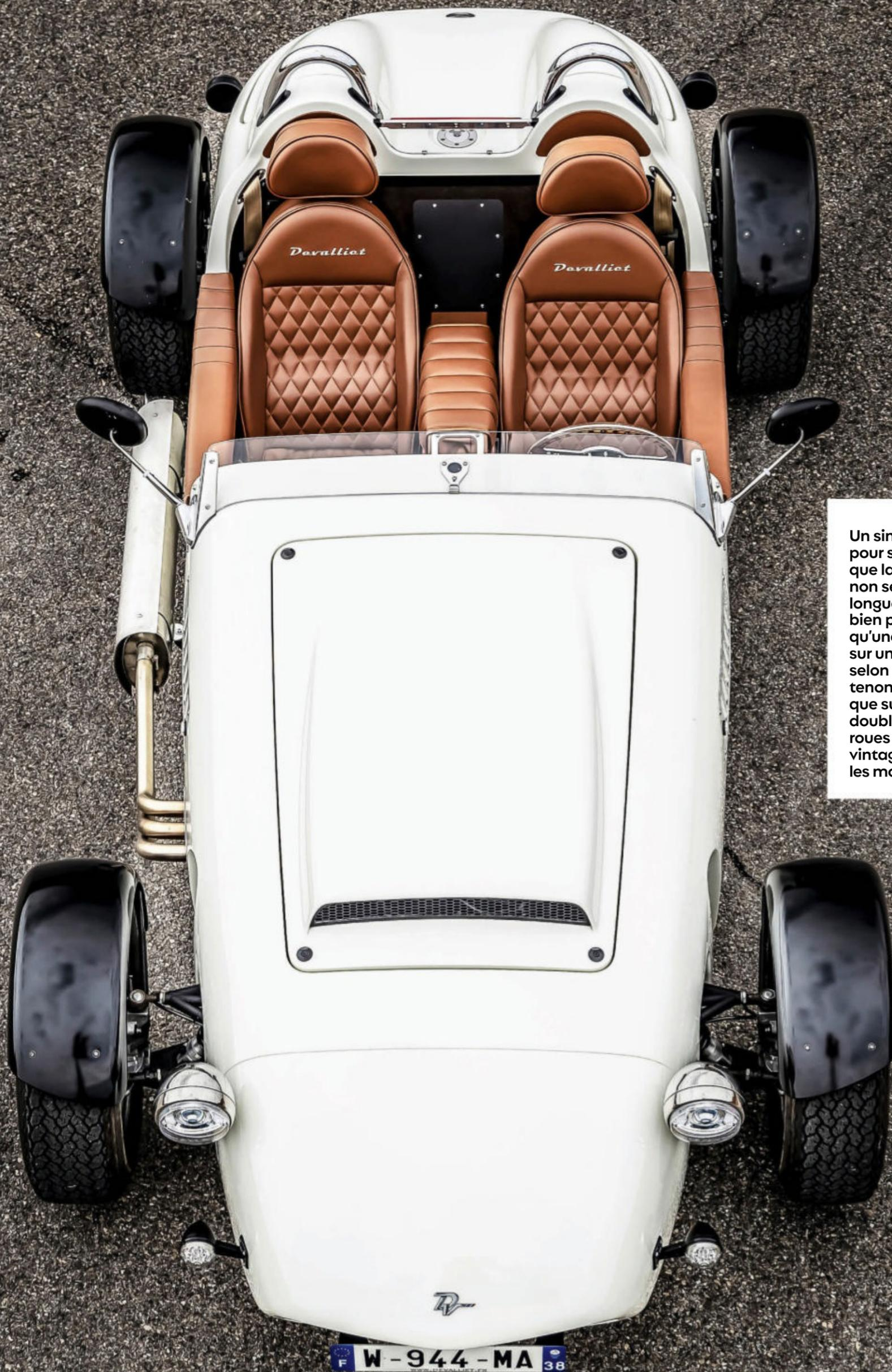
Un simple coup d'œil suffit pour se rendre compte que la Devalliet Mugello est non seulement plus longue (3,86 m) mais aussi bien plus large (1,76 m) qu'une Caterham. Elle repose sur un châssis en aluminium selon le principe d'assemblage tenon-mortaise ainsi que sur des suspensions à double triangulation. Ses roues extérieures et son style vintage rappellent les monoplaces des années 50.
